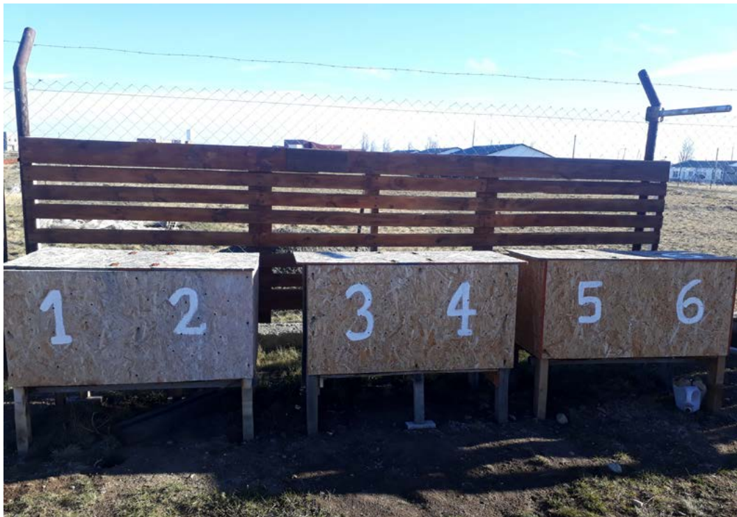
Composteras modulares de la Universidad Nacional de la Patagonia Austral. Los módulos poseen perforaciones en su base para el drenaje de lixiviados y la tapa no es hermética para permitir el ingreso de oxígeno. Fuente: UNPA-UARG. Proyectos "En la universidad y en el barrio: la gestión comunitaria de residuos y Compostaje comunitario en un barrio de Río Gallegos".
