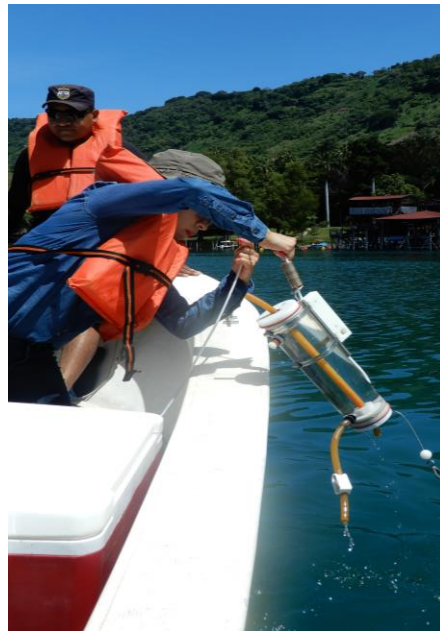
Figura 3. Recolección de muestras de agua con la botella de profundidad de Kemmerer, a una profundidad de 2 metros.
