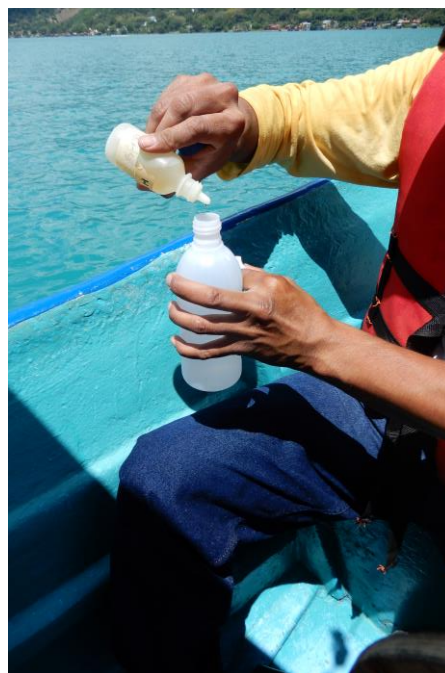
Figura 5. Preservación de muestras de aguas para diversos análisis y posterior traslado al Laboratorio de Calidad de Agua MARN. Fuente: MARN
