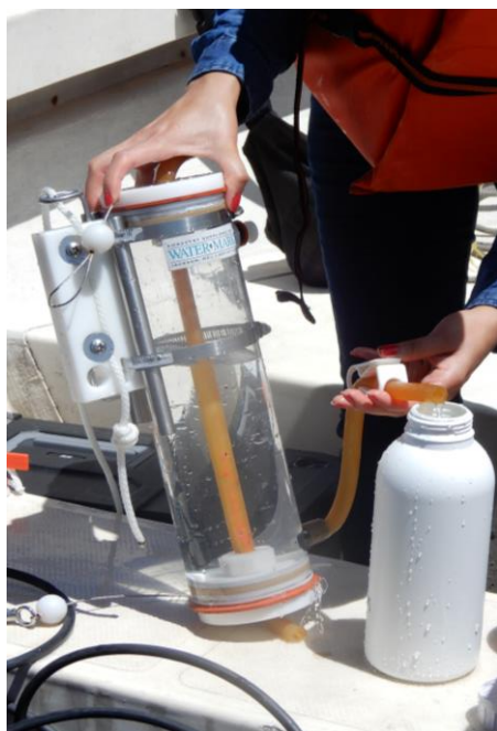
Figura 4. Llenado de frascos con agua para traslado de muestras al Laboratorio de Calidad de Agua MARN Fuente: MARN
