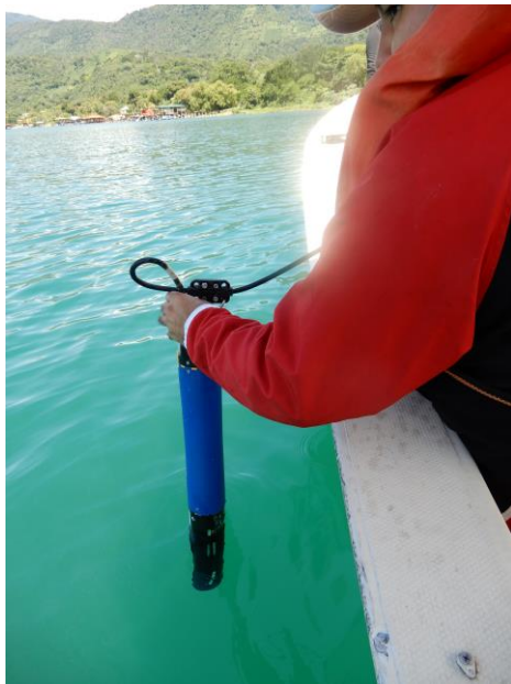
Figura 2. Medición de parámetros de calidad de agua "in situ" con la sonda multiparamétrica de calidad de agua.
