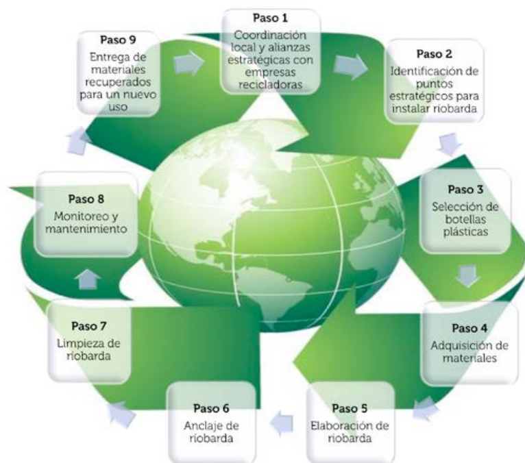
Figura 3. Proceso de elaboración, instalación y mantenimiento de ríobarda
