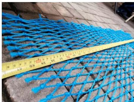
Figura 7. Ancho del corte de malla de 1.05 metros Fuente: MARN, 2019
