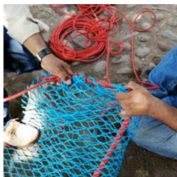
Figura 8. Nudo en extremos de la malla para cerrar la riobarda Fuente: MARN, 2019
