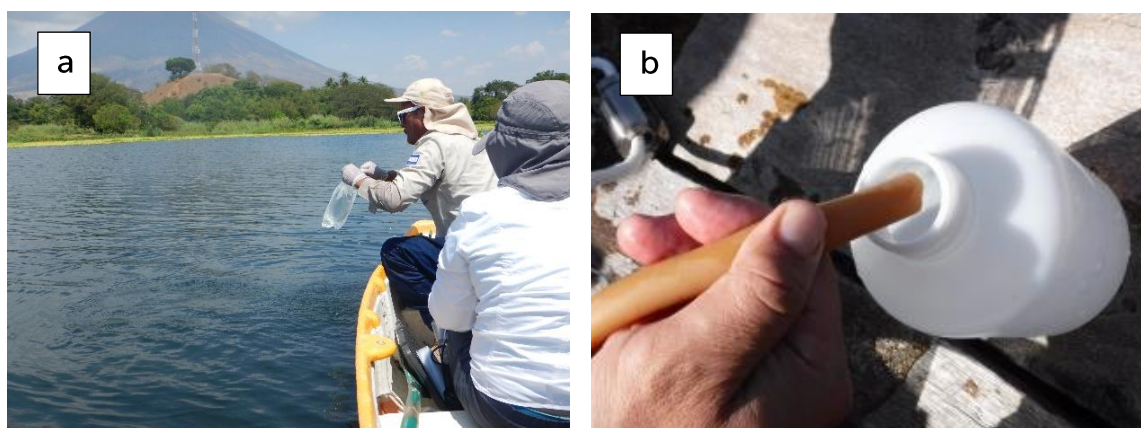
Figura 4. a) Guardarrecursos Leodán Ramírez, tomando la muestra de agua para análisis de coliformes y b) muestra de agua extraída mediante botella de Van Dorn. Fuente: Proyecto MARN-JICA
