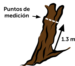
Figura 67. Árbol inclinado en dirección opuesta a la pendiente, en terreno inclinado.
