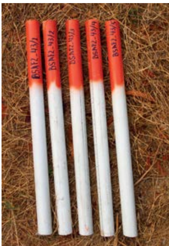
Figura 49. Tubo de PVC de 1" de diámetro y de 50 cm de largo para ubicar el centro de las subparcelas en bosque salado. Fuente: Proyecto TF 099529: Preparación de Propuesta Readiness de El Salvador, MARN, 2017-2018.
