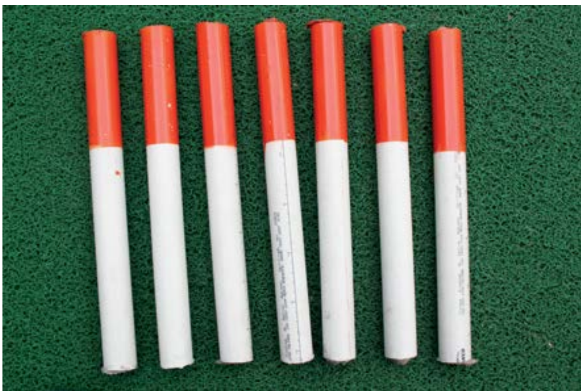
Figura 22. Tubos de PVC de 1" de diámetro y de 30 cm de largo para los estratos BP, BCS, BS, BC y CBS. Fuente: Proyecto TF 099529: Preparación de Propuesta Readiness de El Salvador, MARN, 2017-2018.
