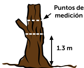
Figura 74. Árbol con protuberancia y rama a 1.3 m: medir el DAP a 20 cm, por encima del final de la protuberancia y rama.
