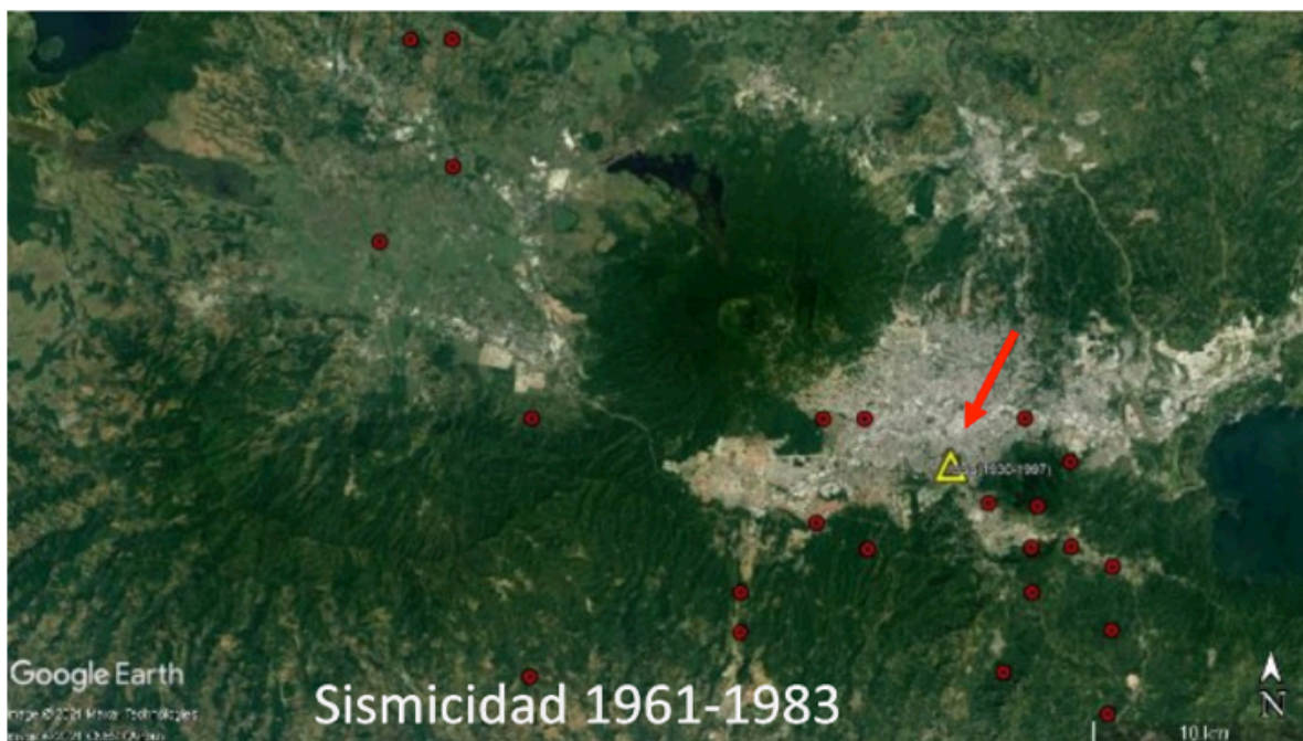
Figura 1. Mapa de ubicación de sismicidad en los años 1961-1983. Puntos rojos (epicentros), triángulo amarillo (estación sísmica).
