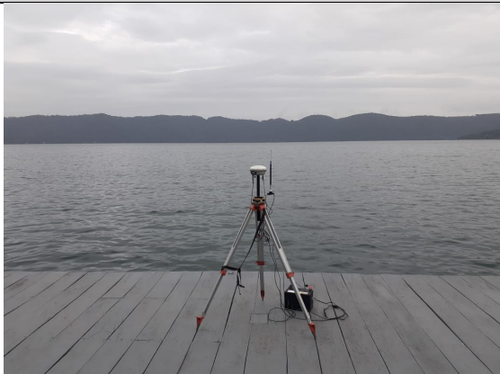
Instalacion de base RTK en Punto de control GPS-2
