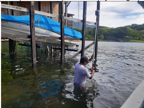
Levantamiento topo-batimetrico en zonas complementarias (obstrucciones por muelles)
