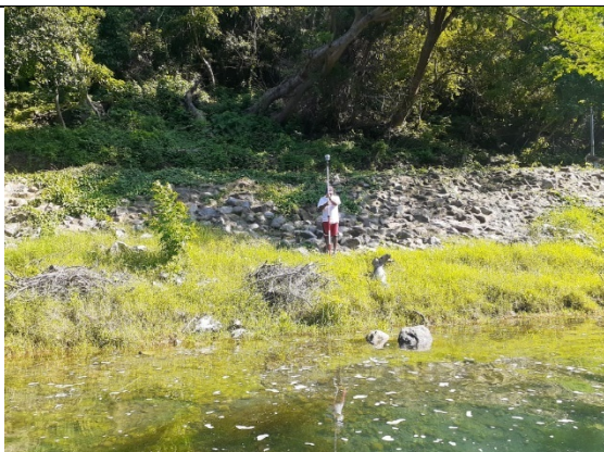
Levantamiento topo-batimetrico en zonas complementarias (fuera de espejo de agua)
