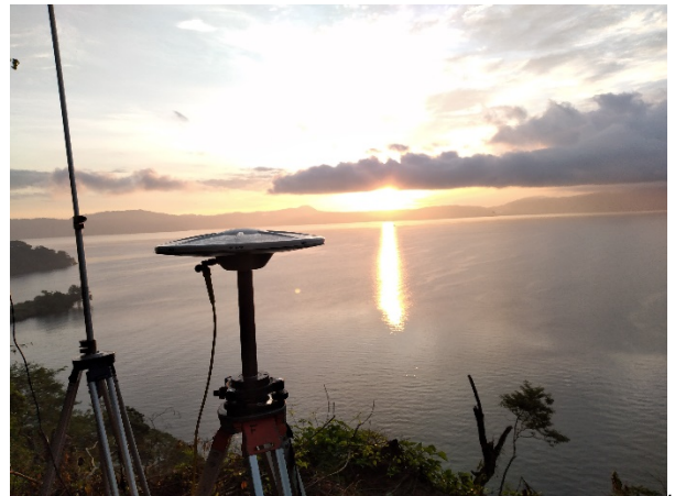
Imagen 9. Instalación de Base Trimble SPS855.
