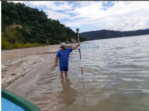
Levantamiento topográfico con GPS en las zonas de poca profundidad
