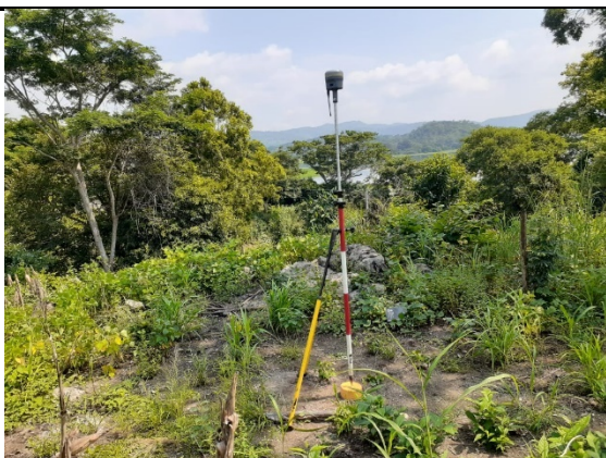
Establecimiento de puntos de control de red auxiliar, con nombre "Aqua Fría".
