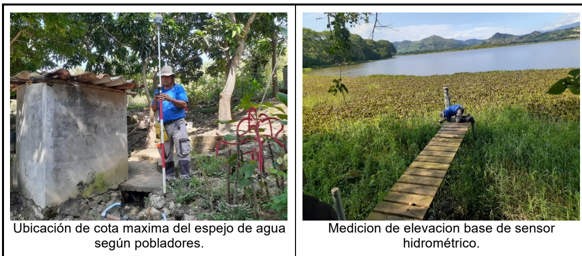
Imagen 11. Ubicación y toma de elevaciones de estación hidrométrica.
