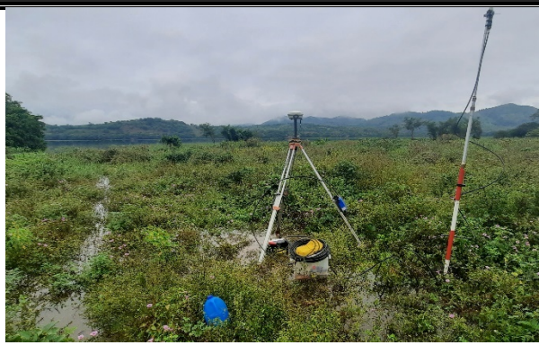
Instalación de base GPS GNSS sobre punto de control "Bendición de Dios".
