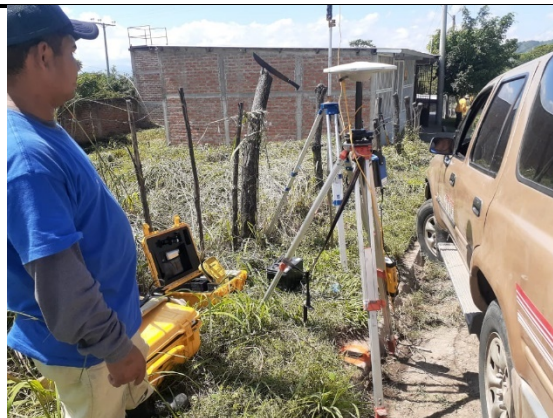
Instalación de base GPS RTK en mojón geodésico.
