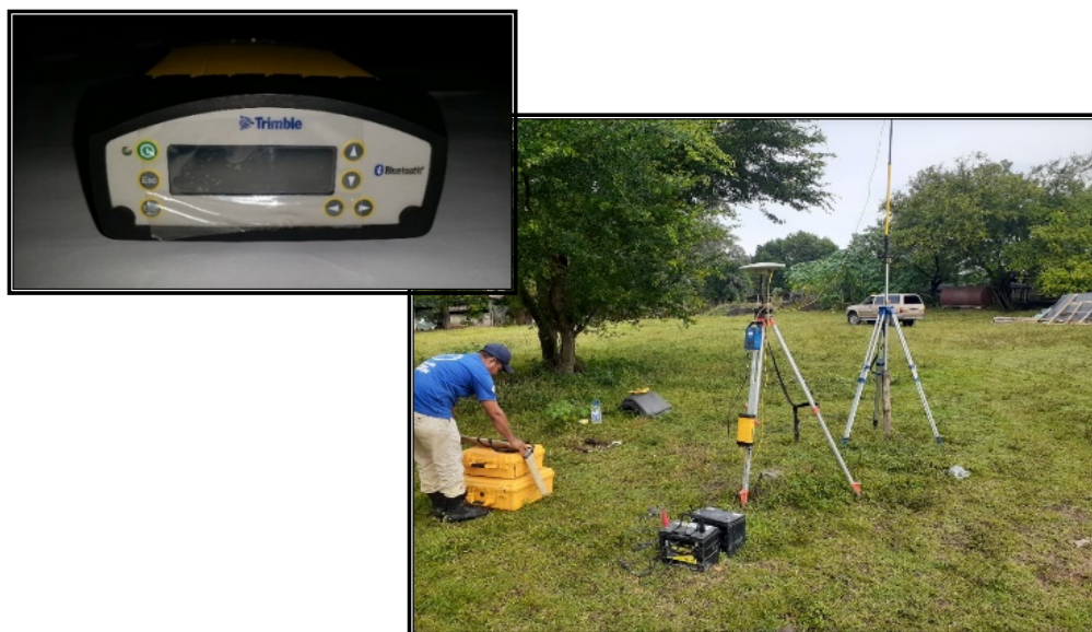
Imagen 28. Instalación de Base Trimble SPS855.
