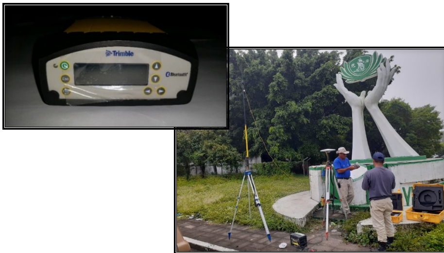
Imagen 49. Instalación de Base Trimble SPS855.
