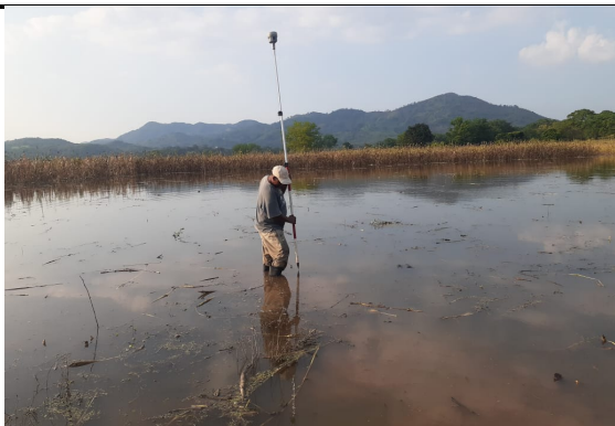
Levantamiento topo-batimétrico en profundidades de hasta 1.0 m de columna de agua.
