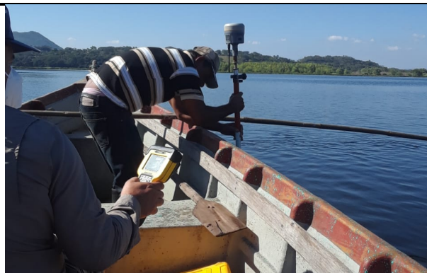
Levantamiento topo-batimétrico en profundidades de hasta 5.0 m de columna de agua.
