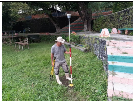
Establecimiento de puntos de control de red auxiliar, con nombre "Turicentro".
