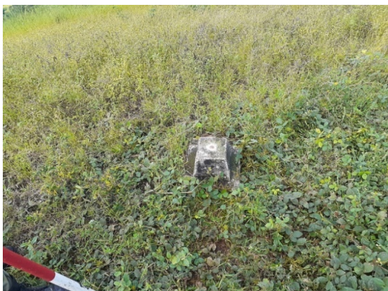
Ubicación de mojón geodésico para georeferenciar puntos geodésicos auxiliares.
