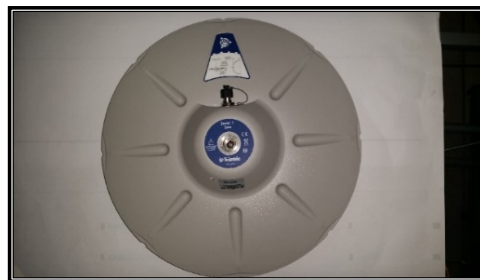
Imagen 51. Antena Trimble Zephyr 3.
