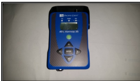
Imagen 9. Radio Receptora/Transmisora marca Pacific Crest.
