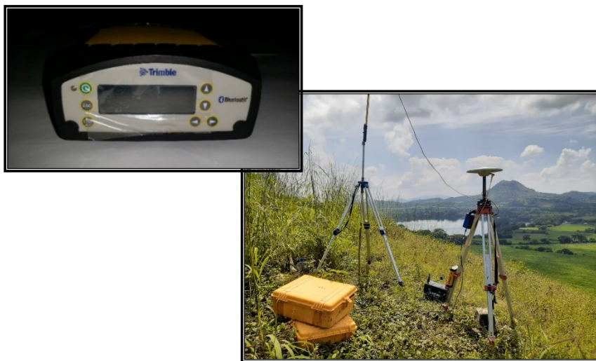
Imagen 72. Instalación de Base Trimble SPS855.
