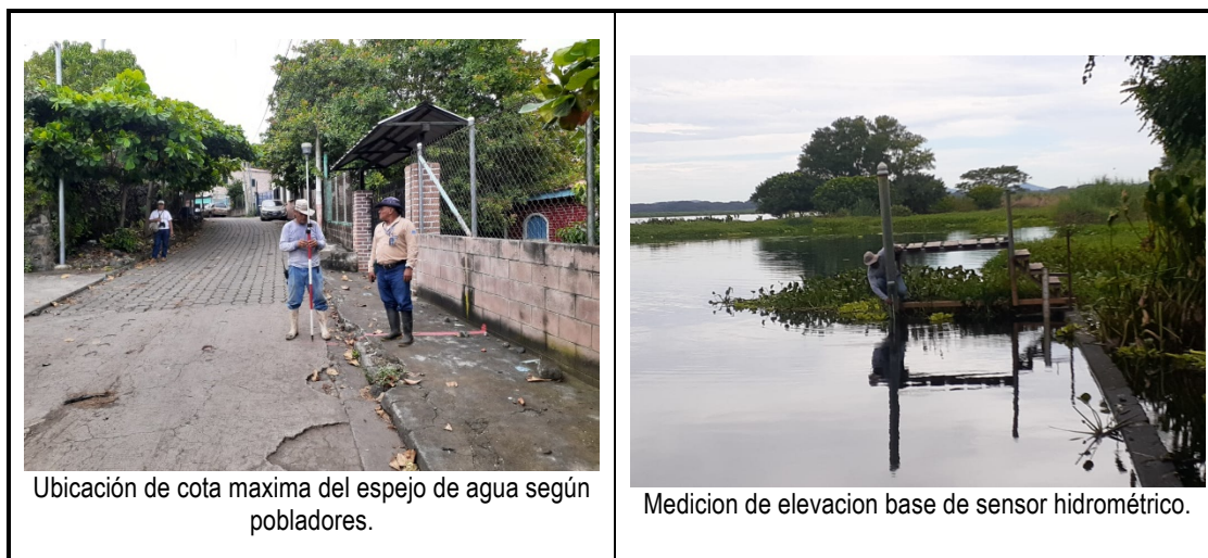
Imagen 32. Ubicación y toma de elevaciones de estación hidrométrica.
