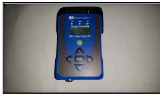
Imagen 52. Radio Receptora/Transmisora marca Pacific Crest.
