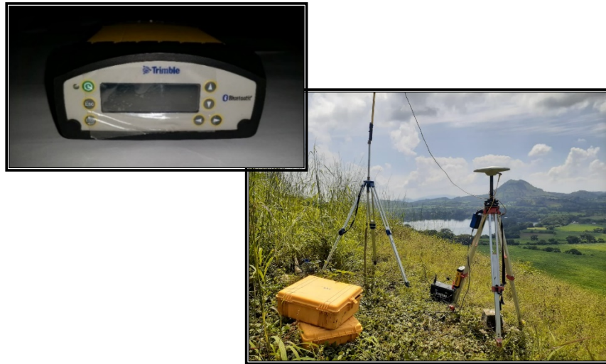
Imagen 7. Instalación de Base Trimble SPS855.
