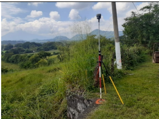
Establecimiento de puntos de control de red auxiliar, con nombre "Apastepeque 1".
