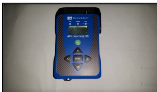
Imagen 74. Radio Receptora/Transmisora marca Pacific Crest.
