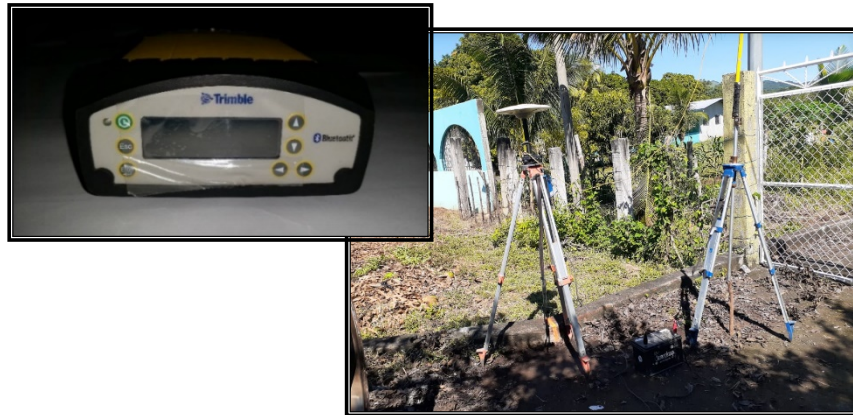
Imagen 50. Instalación de Base Trimble SPS855.
