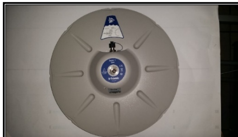
Imagen 29. Antena Trimble Zephyr 3.
