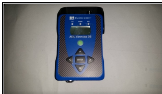
Imagen 30. Radio Receptora/Transmisora marca Pacific Crest.
