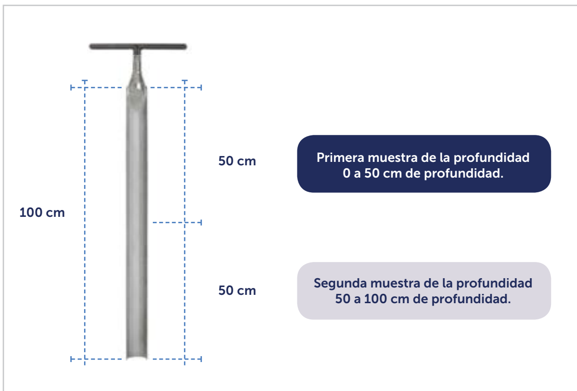
Figura 19. Toma de dos muestras para carbono en suelo en muestreador de suelo de 100 cm de largo y 2" de diámetro, en bosque salado.
