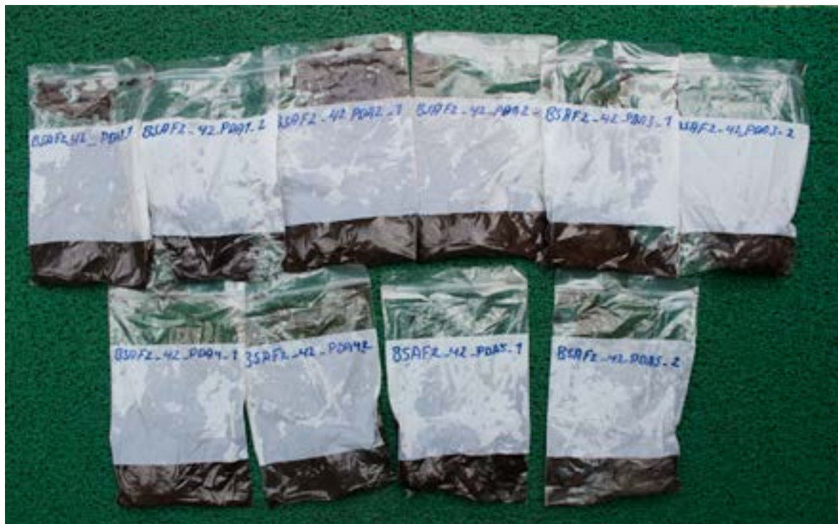
Figura 35. Muestras de suelo preparadas para ser enviadas y calcular la densidad aparente. Fuente: Proyecto TF 099529: Preparación de Propuesta Readiness de El Salvador, MARN, 2017-2018.
