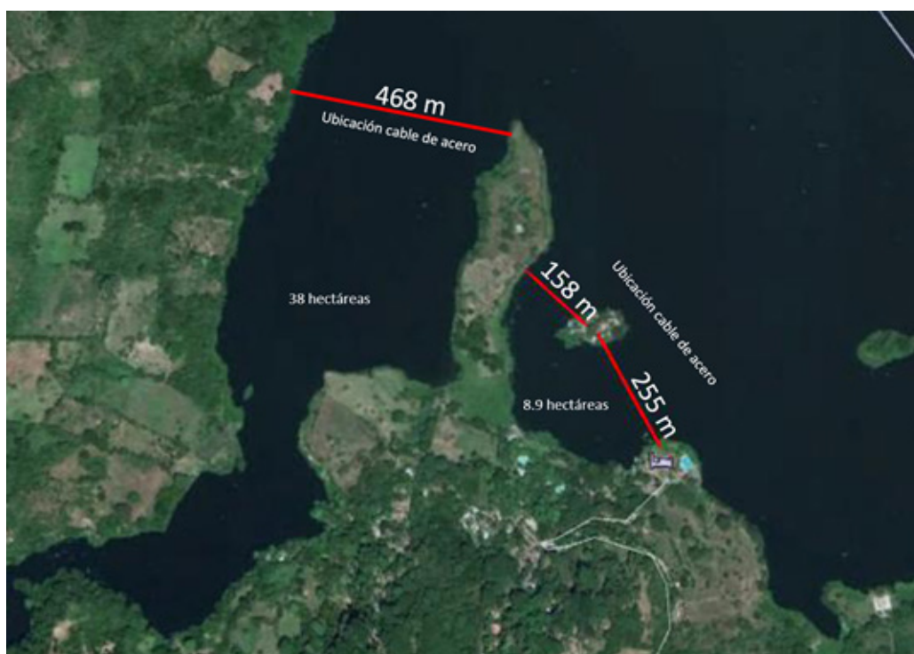
Fig. 1 – Colocación de cables para el control de jacinto de agua en el sitio Ramsar embalse Cerrón Grande, noviembre 2019.
